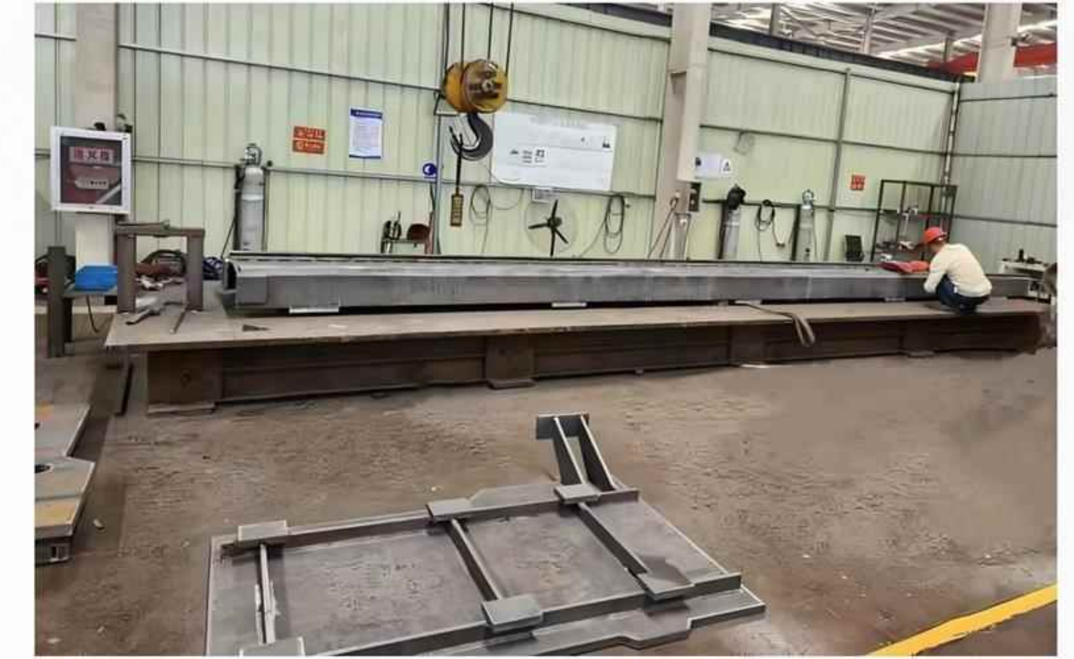
大型溶接作業台
